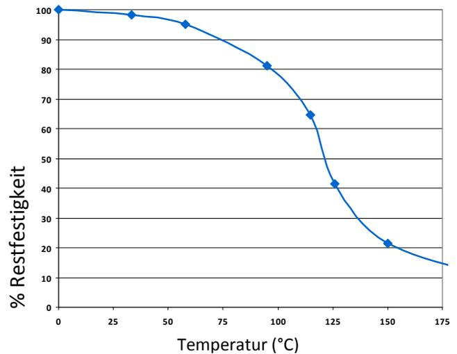
TA435 kann bei geringen Belastungen kurzzeitig auch höheren Temperaturen ausgesetzt werden (z.B. bei Einbrennlack- oder Schwall-Löt-Verfahren). Niedrigste Temperatur bei Endfestigkeit: -55°C (abhängig von den verwendeten Materialien).
