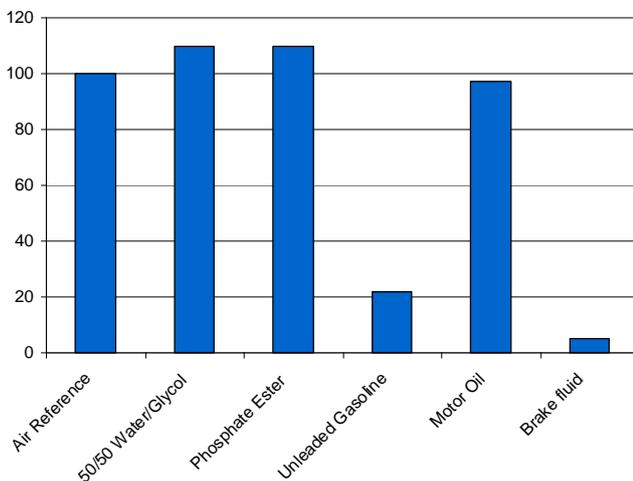
Probestücke wurden 30 Tage lang bei 85°C in den verschiedenen Testflüssigkeiten gehalten und bei Raumtemperatur getestet.
