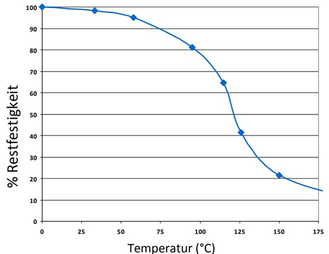
TA430 kann bei geringen Belastungen kurzzeitig auch höheren Temperaturen ausgesetzt werden (z.B. bei Einbrennlack- oder Schwall-Löt-Verfahren). Niedrigste Temperatur bei Endfestigkeit: -55°C (abhängig von den verwendeten Materialien).
