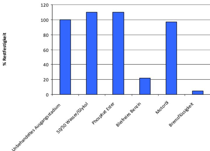
Probestücke wurden 30 Tage lang bei 85°C in den verschiedenen Testflüssigkeiten gehalten und bei Raumtemperatur getestet.
