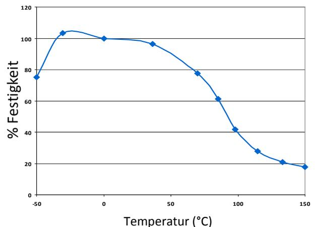
„Hitzebeständige“ Scherfestigkeitsversuche wurden auf Weichstahl durchgeführt. Aushärtung bei Raumtemperatur über 24 Stunden. Vor den Testversuchen wurden die Teile über 30 Minuten auf der Testtemperatur gehalten.
