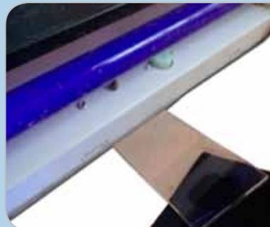
8. Klebefläche mit UV-Licht bestrahlen bis der Klebstoff vollständig ausgehärtet ist
