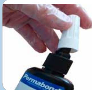
6. Flasche wieder verschließen um zu verhindern, dass der restliche Klebstoff mit UV-Licht bestrahlt wird
