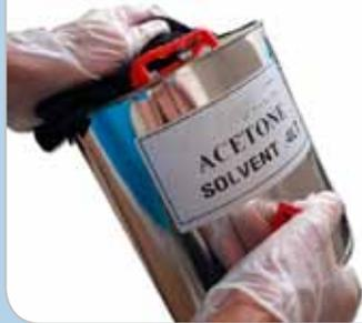
3. Oberflächen reinigen mit Aceton, Isopropanol oder mit Permabond Cleaner A
