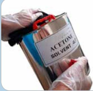
3. Oberflächen reinigen mit Aceton, Isopropanol oder mit Permabond Cleaner A (vor dem Schleifen)
