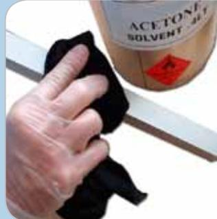
5. Nochmals reinigen um Schleifstaub und abgetragenes Material zu entfernen
