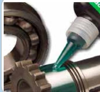
6. Klebstoff in einer durchgängigen Raupe auftragen. Teile unter Drehen fügen um sicherzustellen, dass Klebstoff in allen Bereiche vorhanden ist
