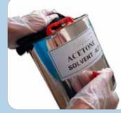
3. Oberflächen reinigen mit Aceton, Isopropanol oder mit Permabond Cleaner A
