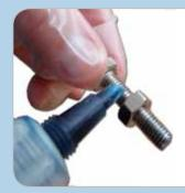
7. Den Klebstoff an der Position auftragen, wo die Mutter postioniert werden soll
