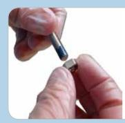
6. Klebstoff auf die Kontaktfläche auftragen und Teile verschrauben
