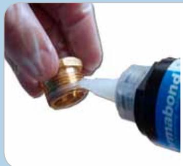
6. Ausreichend Material 1-2 Gewingegänge von der Vorderkante auf das Außengewinde aufbringen. (bei konischen Gewinden im Bereich der größten Kontaktfläche)
