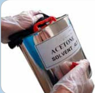
3. Oberflächen reinigen mit Aceton, Isopropanol oder mit Permabond Cleaner A
